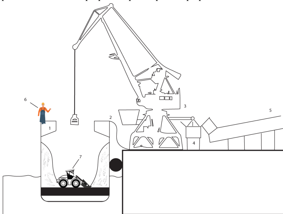
1- Кораб ; 2 - Бордова пала ; 3 - Портален кран с бункер кош ; 4 - Гумено-лентов транспортър ; 5 - Заводска лента 6 - Докер ; 7 - Челно-кофъчен товарач
